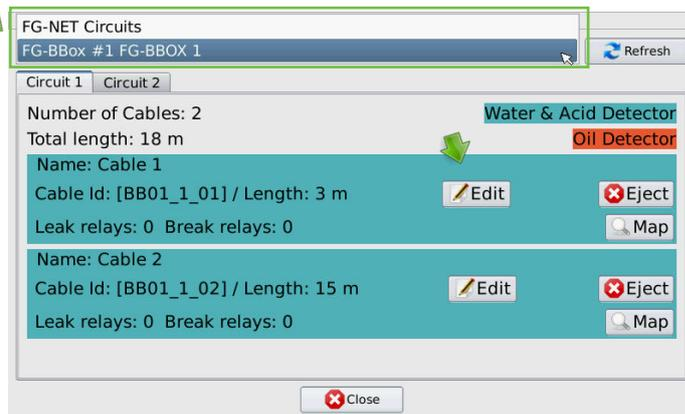
FR La configuration des câbles détecteurs connectés sur FG-BBOX est similaire à celle sur FG-NET. Sur la page d'accueil de FG-NET, cliquer sur l'icône « Câbles », puis aller dans le menu déroulant et sélectionner FG-BBOX #N pour visualiser tous les câbles connectés sur ce boîtier.
