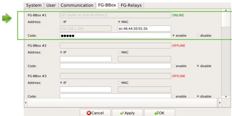
FR Un lien doit être créé entre FG-NET et FG-BBOX. Dans le menu « Configuration » de FG-NET, sous l'onglet « FG-BBOX », sélectionner un champ disponible et entrer l'adresse IP de FG-BBOX ou l'adresse Mac et le code. Appuyer sur le bouton « enable », le nom du FG-BBOX apparaîtra et son état passera à « en ligne ».
