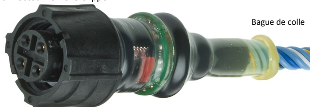
Manchon thermo rétractable (transparent) avec le module électronique et son microcontrôleur
